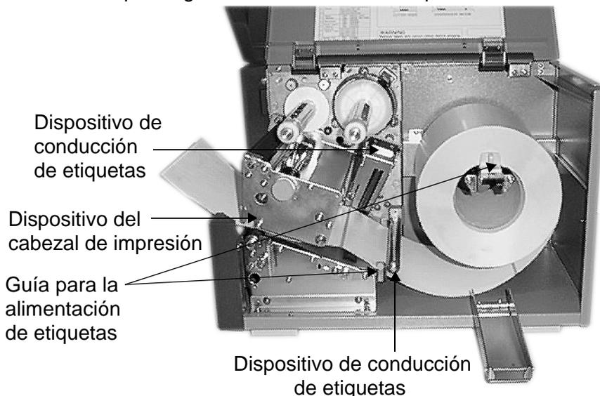
6. Comprobar el recorrido de las etiquetas y asegurarse de que éste corresponda al recorrido que se aprecia en la figura. Ajustar las guías ajustables de etiquetas de tal manera que las etiquetas se apoyen en la pared de la impresora.
