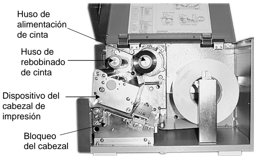
4. Pasar el mandril de la cinta de impresión hacia el centro sobre el eje de rebobinado de cinta hasta que éste se apoye directamente en el extremo del eje. Tómese en cuenta que el mandril vacío de un rollo sirve como mandril de rebobinado de la siguiente cinta.
