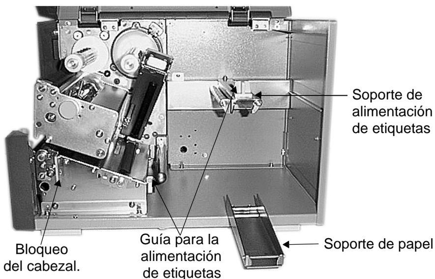
4. Desplazar el rollo de papel en el soporte para alimentación de etiquetas. Asegúrese de que la cara de impresión de las etiquetas indique hacia arriba cuando éstas sean introducidas en la impresora. Deslizar el rollo completamente hacia el interior; deslizar la guía para alimentación de etiquetas hacia el interior hasta que ésta se apoye directamente en el lado exterior del rollo de papel.
