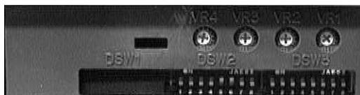
Para la configuración de los interruptores, desconectar primero la impresora y conmutar después los interruptores DIP a la posición deseada. Conectar después la impresora. El sistema electrónico de la impresora lee la configuración de los interruptores durante la conexión. Es decir, la configuración solamente se aplicará después de haber conectado otra vez la impresora.
